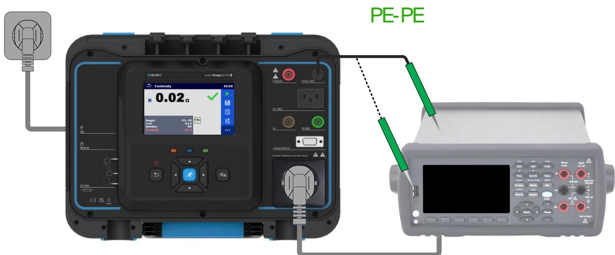
Abbildung 100_Durchgang der Schutzterde
