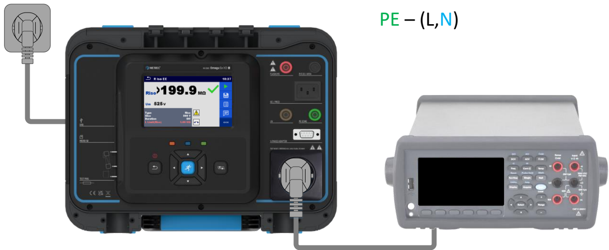
Abbildung 102_Isolationswiderstand Klasse I
