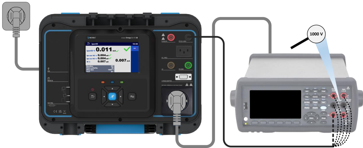
Abbildung 106_Ifi_Alternative Methode Klasse I
