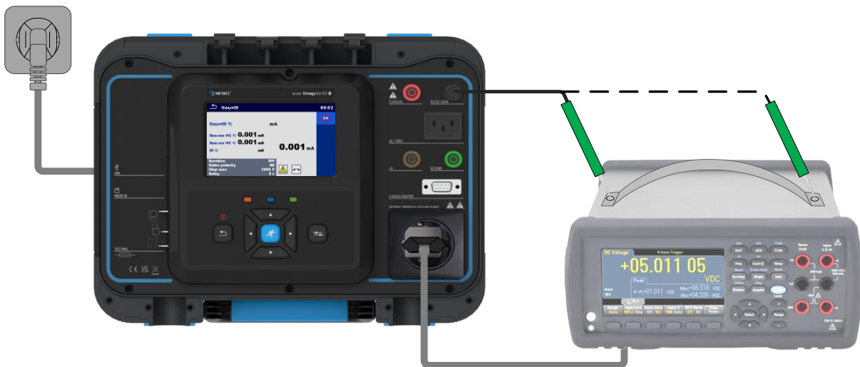
Abbildung 108_Berührungsableitstrom (Klasse II)
