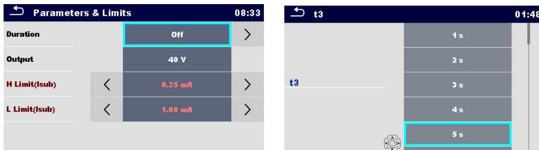
Abbildung 6.3: Fenster im Menü für das Einstellen von Parametern und Grenzwerten für Einzeltests
