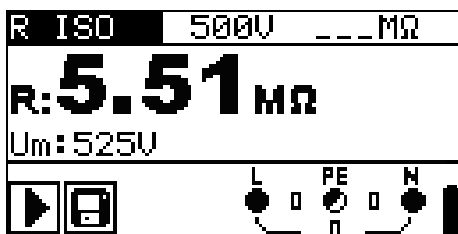
Bild 5.7: Beispiel für ein Ergebnis einer Isolationswiderstandsmessung
