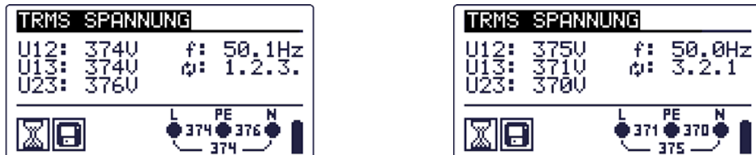
Bild 5.4: Beispiel für eine Spannungsmessung im Drehstromnetz
