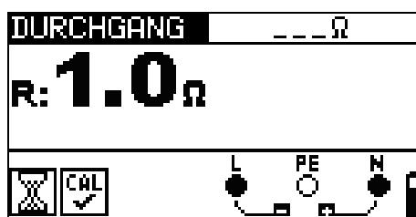
Bild 5.12: Beispiel für die kontinuierliche Widerstandsmessung
