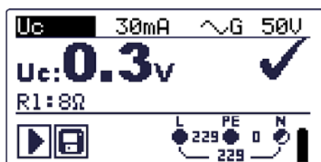
Bild 5.18: Beispiel für die Ergebnisse einer Berührungsspannungsmessung
