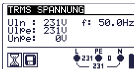
Bild 5.1: Spannung in einem Einphasennetz
