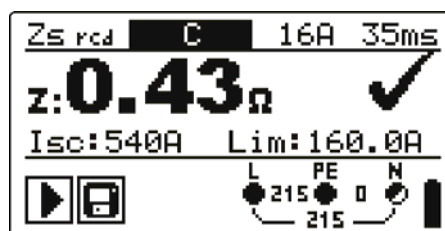
Bild 5.25: Beispiele für Messergebnisse der Schleifenimpedanz
