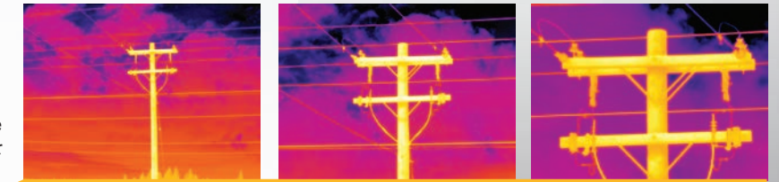
Standardobjektiv (links), 2-fach-Teleobjektiv (Mitte) und 4-fach-Teleobjektiv (rechts) – für die richtige Detaildarstellung wichtiger Details
