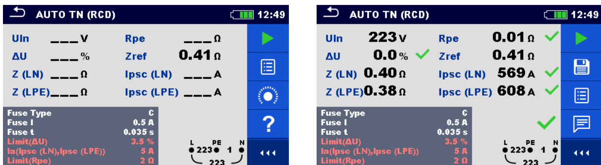
Abbildung 4.77: Beispiele für Ergebnisse der AUTO TN (RCD)-Messung
