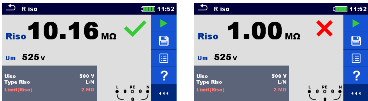
Abbildung 4.8: Beispiele für Ergebnisse der Isolationswiderstandsmessung
