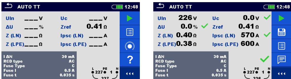
Abbildung 4.74: Beispiele für Ergebnisse der AUTO TT-Messung
