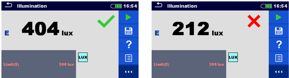
Abbildung 4.71: Beispiele für Ergebnisse der Beleuchtungsstärkemessung
