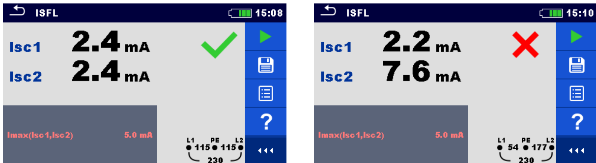
Abbildung 4.65: Beispiele für Ergebnisse des Erstfehler-Ableitstroms
