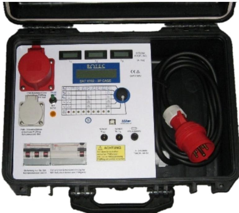
Das Prüfgerät SAT 0702 (-3P) dient zur Prüfung der elektrischen Sicherheit von einphasigen (-3P von einphasigen und dreiphasigen) elektrischen Geräten.
