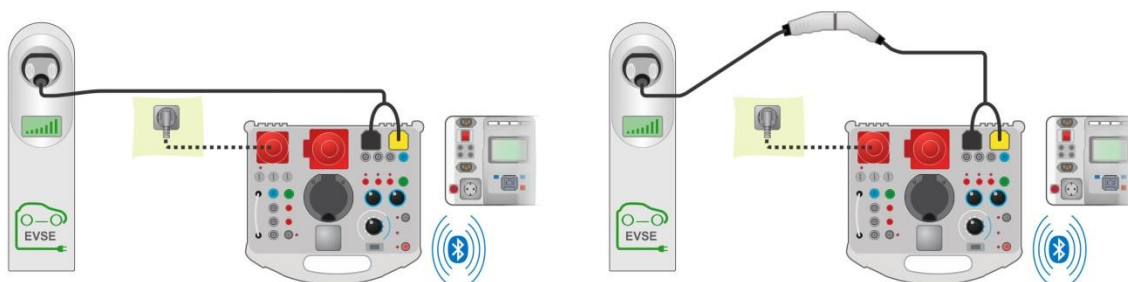
Abbildung 6.104: Diagnostischer Test - Ev-Simulator und Fehler Teilprüfungen - Verbindung mit EVSE
