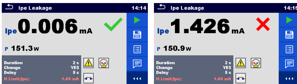
Abbildung 6.47: Beispiele für Ergebnisse Schutzleiterableitstrom Messung
