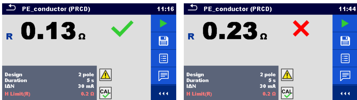
Abbildung 6.120: Beispiele für Ergebnisse der Schutzleiterprüfung (PRCD)
