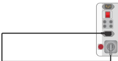
Abbildung 6.22: Kompensation zwischen Netzprüfsteckdose und IEC Steckdose
