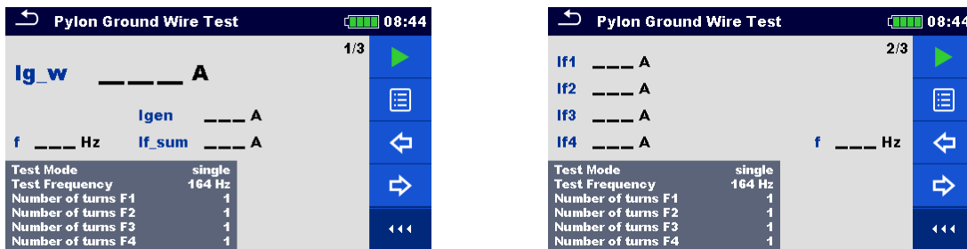
Abbildung 11.84: Menü Hochspannungsmast - Erdleitungsprüfung
