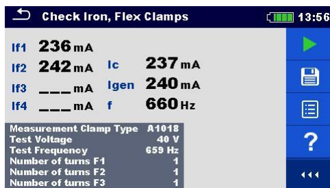
Abbildung 11.108: Beispiel Stromzangen, flexible Stromzangen - Prüfung Ergebnis
