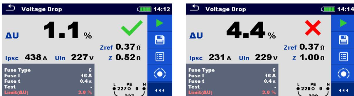
Abbildung 7.70: Beispiel für das Messergebnis der Spannungsfallmessung (Schritt 2)
