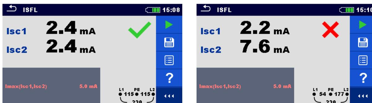
Abbildung 7.39: Beispiel für die Messergebnisse Fehlerstrom des ersten Fehlers
