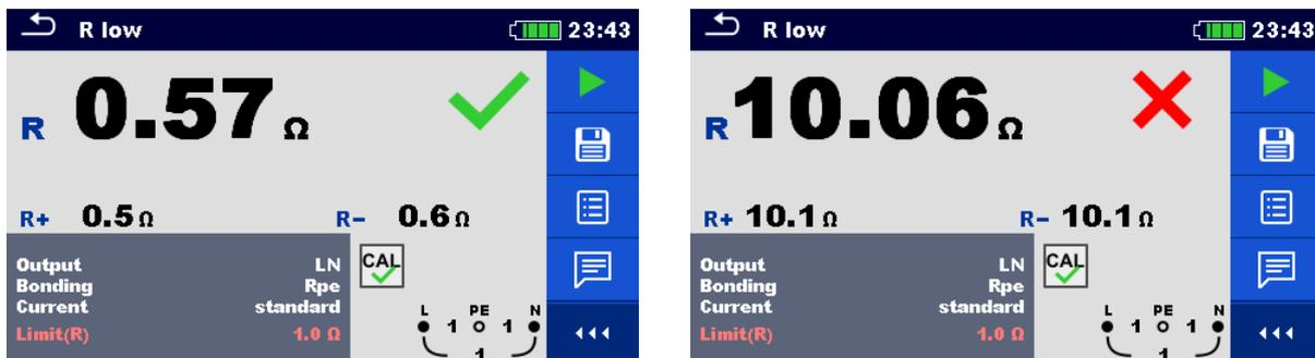
Abbildung 7.24: Beispiele für Ergebnisse der R low Messung
