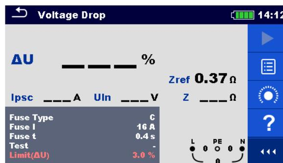
Abbildung 7.69: Beispiel für das Zref Messergebnis (Schritt 1)
