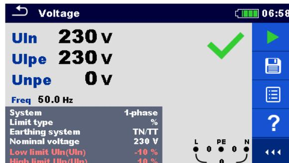
Abbildung 7.4: Beispiel für Spannungsmessung in einem Ein-Phasen-System
