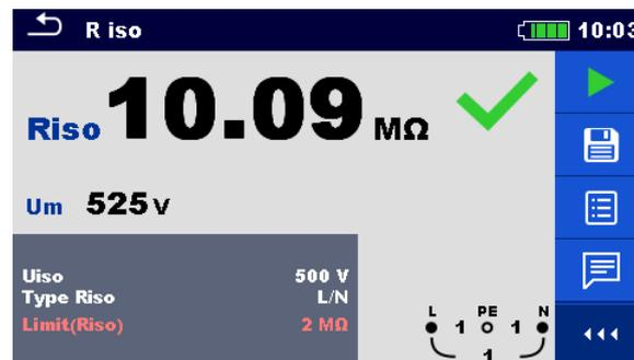
Abbildung 6.4: Einzelprüfung Ergebnis-Bildschirm, Beispiel für Ergebnisse der Isolationswiderstandsmessung
