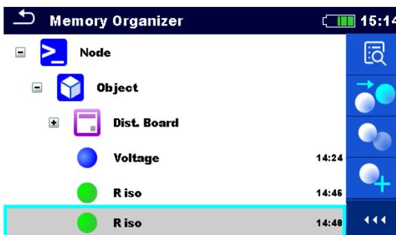
Die Wiederholungsprüfung ist unter dem gleichen Strukturobjekt wie das Original gespeichert.
