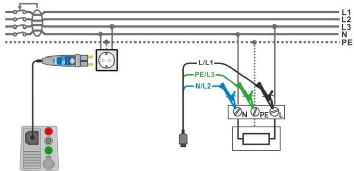
Abbildung 7.48: Anschluss des Commander-Prüfsteckers und des 3-Leiter Prüfadapters
