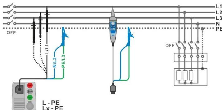
Abbildung 7.11: Anschluss des 3-Leiter Prüfadapters und der Commander-Prüfspitze (U<sub>N</sub> ≤ 1 kV)
