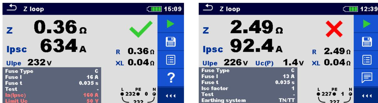
Abbildung 7.43: Beispiel für das Ergebnis einer Schleifenimpedanzmessung
