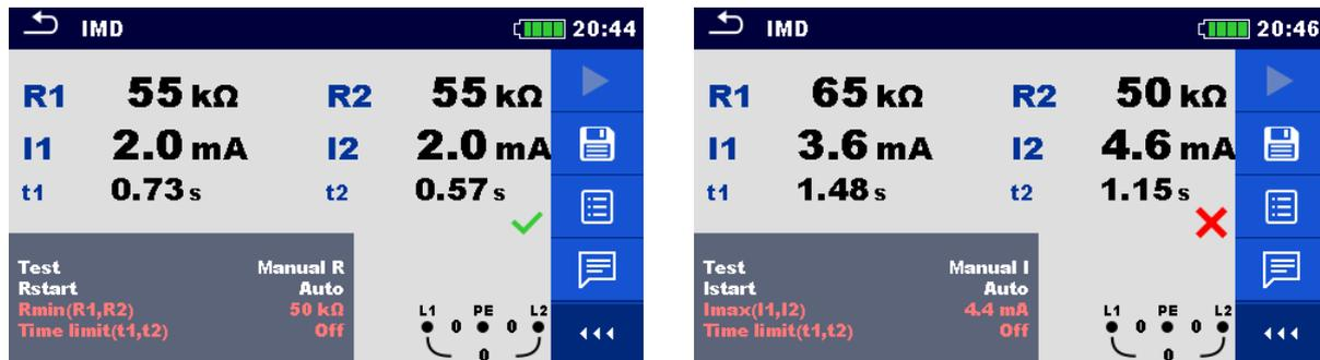
Abbildung 7.42: Beispiele für Ergebnisse der IMD Prüfung
