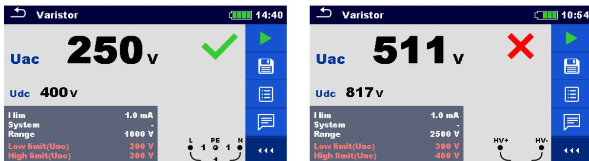
Abbildung 7.21: Beispiele für Ergebnisse der Varistor Prüfung
