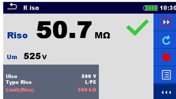
Abbildung 8.6: Auto Sequence® – Beispiel für eine beendete Messung mit Optionen für die Vorgehensweise
