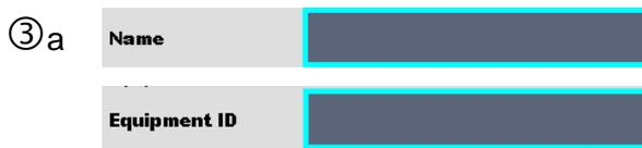
Die Suche kann verkürzt werden, indem ein Text in die Felder der Name und die Prüflings ID eingegeben wird.
