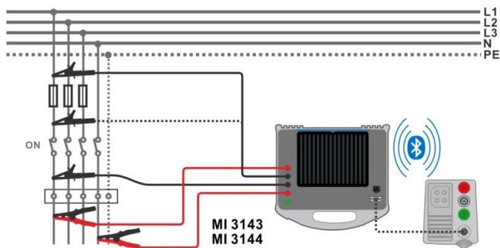
Abbildung 7.65: Hochstrom Widerstandsmessung
