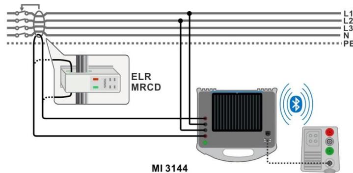
Abbildung 7.80: ELR- Fehlerstromeinspeisung / Kombinierte Auslösezeit
