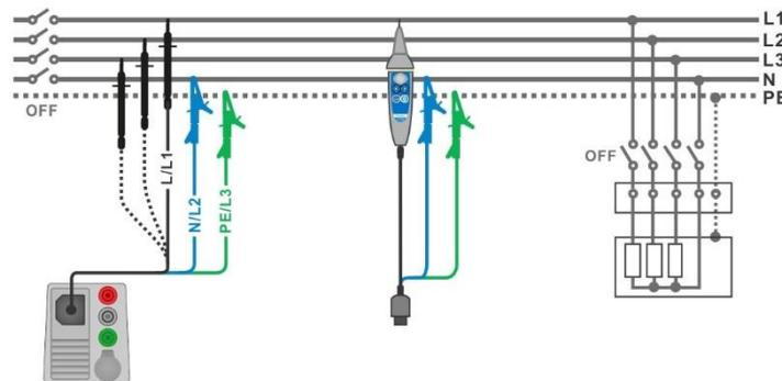
Abbildung 7.12: Anschluss des 3-Leiter Prüfadapters und der Commander-Prüfspitze
