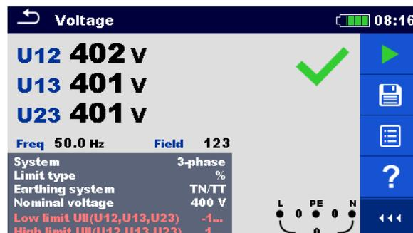
Abbildung 7.5: Beispiele für Ergebnisse der Spannungsmessung im Drei-Phasen-System
