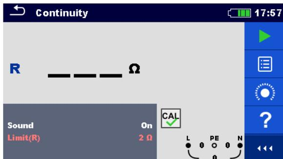
Abbildung 7.28: Menü Druchgangs-Widerstandsmessung
