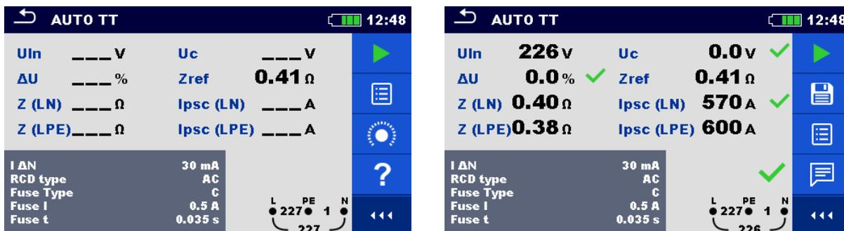
Abbildung 7.55: Beispiele für Ergebnisse der AUTO TT Messung
