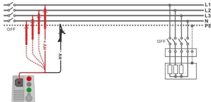
Abbildung 7.16: Anschluss der 2,5 kV Prüflleitung ( $U_N = 2,5 \text{ kV}$ )
