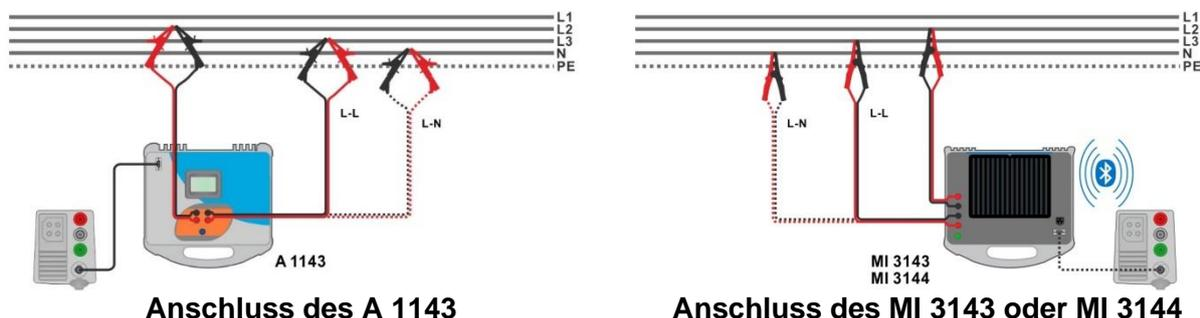
Abbildung 7.62: Hoch präzise Messung der Leitungsimpedanz Phase-Neutralleiter oder Phase-Phase
