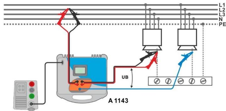
Abbildung 7.53: Messung Berührungsspannung - Anschluss am A 1143
