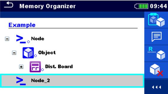
Wählen Sie einen neuen Ort, an den das Strukturobjekt (mit Unterstrukturen und Messungen) verschoben werden soll.
