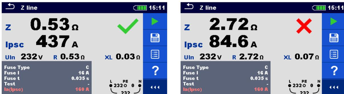
Abbildung 7.57: Beispiele für Ergebnisse der Leitungsimpedanz Messung
