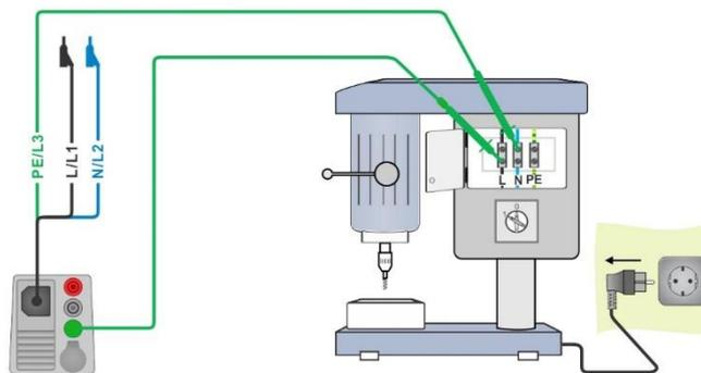
Abbildung 7.51: Messung Restspannung
