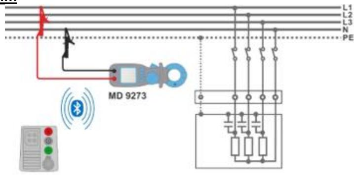
Abbildung 7.86: Harmonics U CLAMP Anschluss
