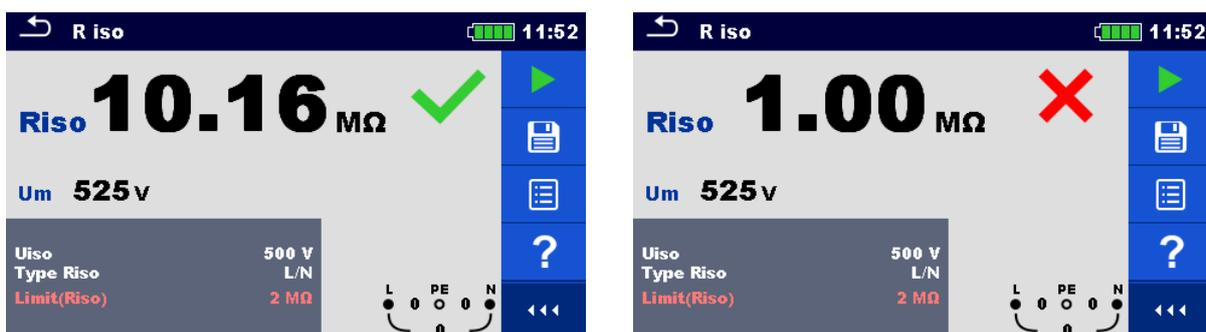
Abbildung 7.9: Beispiele für Ergebnisse der Isolationswiderstandsmessung
