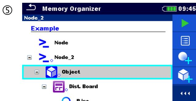
Das Strukturobjekt (mit Unterstrukturen und Messungen) wird an den ausgewählten neuen Standort verschoben und vom vorherigen Standort in der Baumstruktur gelöscht.
