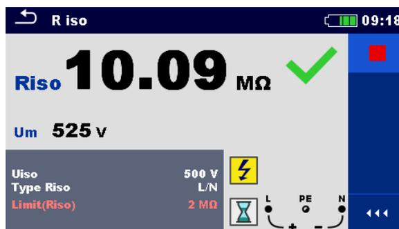
Abbildung 6.1: Aufbau Einzelprüfungs-Bildschirm, beispielsweise von der Isolationswiderstandsmessung
