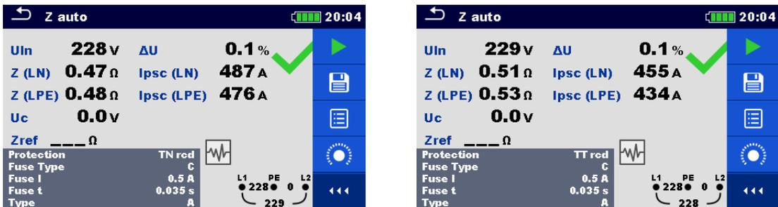
Abbildung 7.76: Beispiele für Ergebnisse der Z Auto Messung
