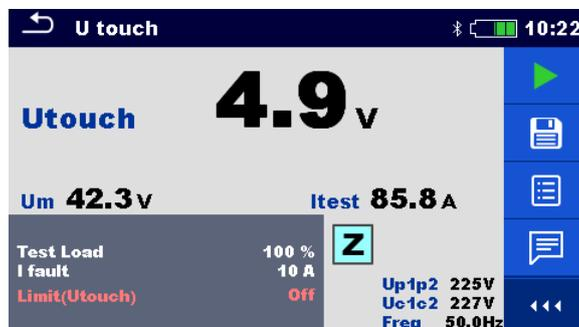
Abbildung 7.73: Beispiele für die Ergebnisse einer Berührungsspannungsmessung
