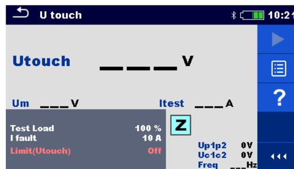
Abbildung 7.71: Menü Berührungsspannung
