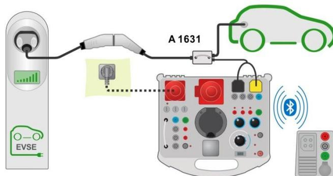
Abbildung 7.87: Diagnoseprüfung (EVSE) - Monitor- Unterprüfungen - Anschluss an EVSE oder Ladekabel
