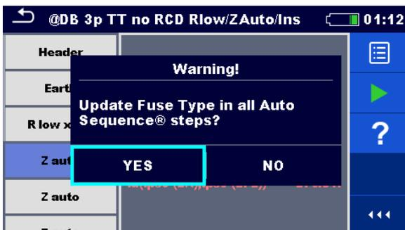
Der Prüfer muss entscheiden, ob die Änderungen der globalen Parameter für alle Einzelprüfungen innerhalb der ausgewählten Auto Sequence® gelten, die die geänderten Parameter enthalten, oder nur für die bearbeitete Einzelprüfung.
