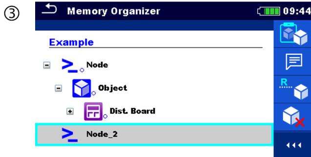
Wählen Sie einen neuen Ort, an den das Strukturobjekt (mit Unterstrukturen und Messungen) verschoben werden soll.
