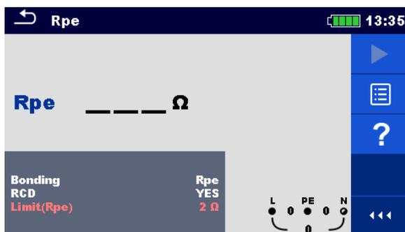
Abbildung 7.43: Menü Schutzleiterwiderstandsmessung
