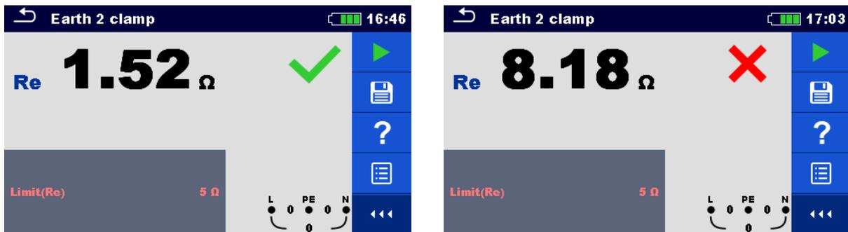
Abbildung 7.20: Beispiele für Ergebnisse der Berührungslosen Erdungswiderstandsmessung
