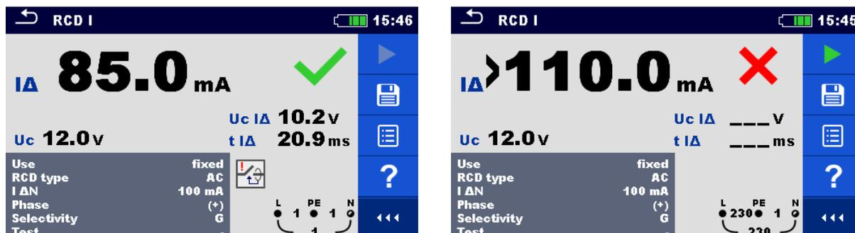
Abbildung 7.14: Beispiele für die Messergebnisse des Auslösestroms
