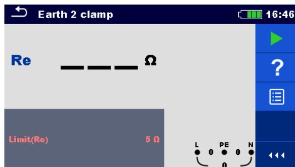
Abbildung 7.18: Menü Erder- $\Omega$  2 Zangen (C3)
