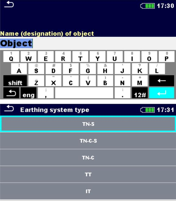
Im Menü Bearbeitung der Parameter können die Parameterwerte von einer Drop-Down-Liste ausgewählt, oder mit der Tastatur eingegeben werden. Für weitere Informationen zur Tastaturbedienung siehe Kapitel 4 *Bedienung des Prüfgeräts*.
