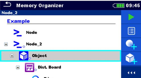
Das Strukturobjekt (mit Unterstrukturen und Messungen) wird an den ausgewählten neuen Standort verschoben und vom vorherigen Standort in der Baumstruktur gelöscht.
