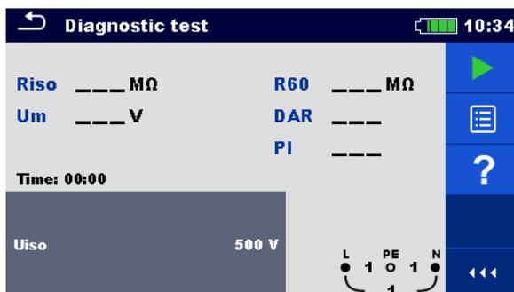
Abbildung 7.14: Menü Diagnose Prüfung
