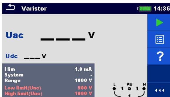
Abbildung 7.12: Hauptmenü Varistor Prüfung
