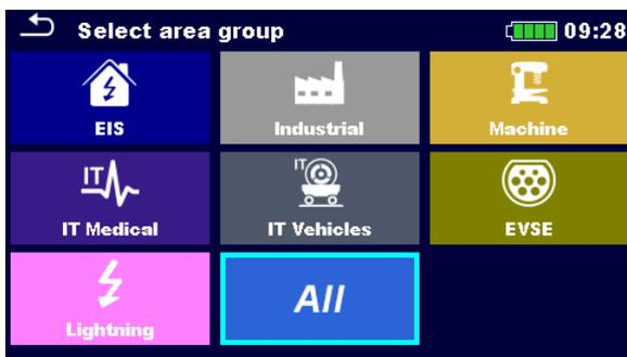
Mit Hilfe von Arbeitsbereichen ist es möglich, die angebotenen Einzelprüfungen einzugrenzen. Das Prüfgerät verfügt über verschiedene Arbeitsbereiche:
