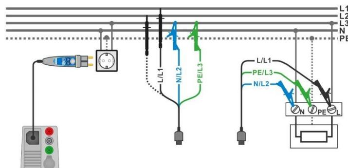
Abbildung 7.56: Phase-Neutraleiter- oder Phase-Phase Messung der Leitungsimpedanz - Anschluss des Commander-Prüfsteckers und den 3-Leiter Prüfadapter
