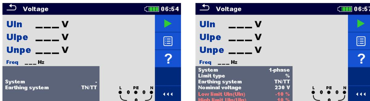
Abbildung 7.1: Menü Spannungsmessung
