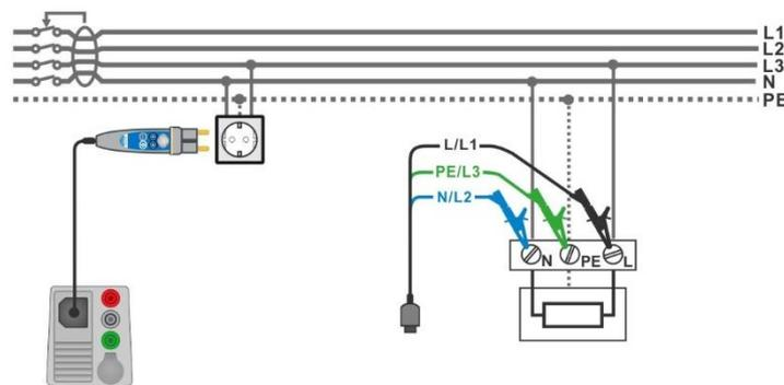
Abbildung 7.34: Anschluss des Commander-Prüfsteckers und die 3-Leiter Prüfadapter
