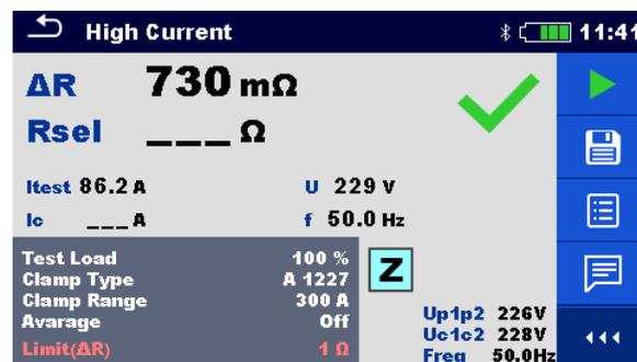
Abbildung 7.66: Beispiel für das Ergebnis der Hochstrom Messung
