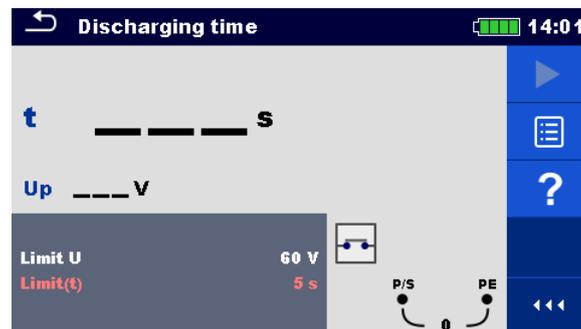
Abbildung 7.49: Menü Restspannungsprüfung
