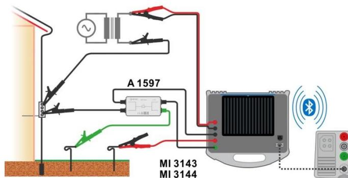
Abbildung 7.72: Messung Berührungsspannung - Anschluss des MI 3143 oder MI 3144
