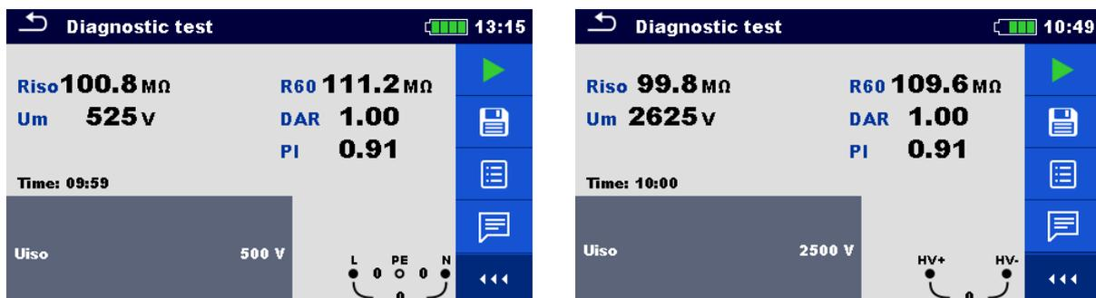
Abbildung 7.17: Beispiele für Ergebnisse der Diagnoseprüfung
