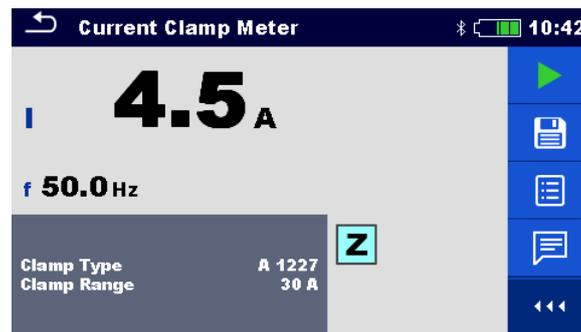
Abbildung 7.35: Beispiele für das Ergebnis der Stromzangenmessung
