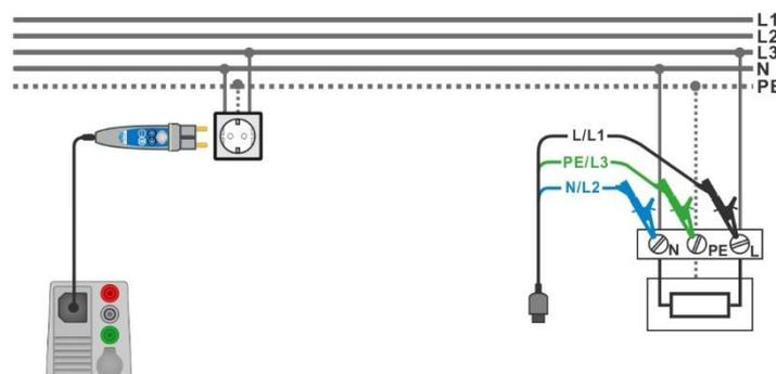
Abbildung 7.15: Anschluss des Commander-Prüfsteckers und des 3-Leiter Prüfadapters
