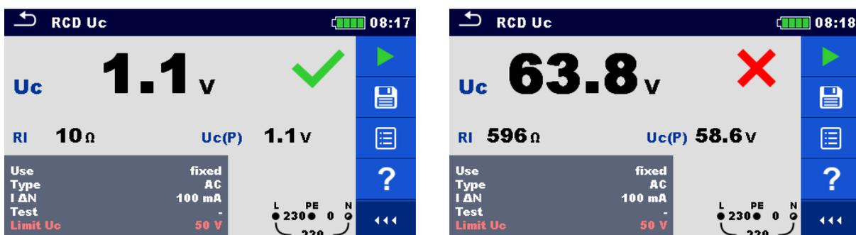
Abbildung 7.36: Beispiele für die Ergebnisse einer Berührungsspannungsmessung
