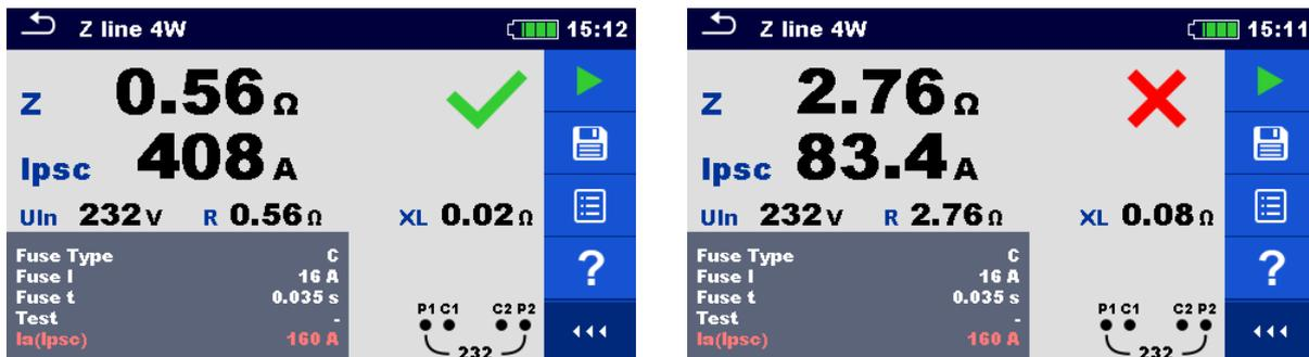
Abbildung 7.60: Beispiele für Ergebnisse der 4W Leitungsimpedanz-Messung
