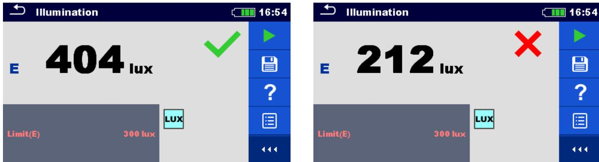
Abbildung 7.48: Beispiele für Ergebnisse Beleuchtungsstärkemessung
