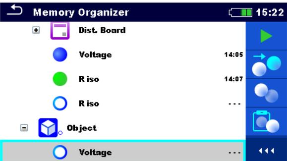
Die neue (leere) Messung wird im ausgewählten Strukturobjekt angezeigt.
