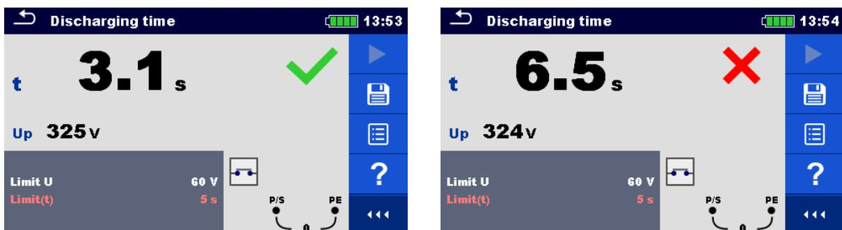
Abbildung 7.52: Ergebnisse Messung Restspannung
