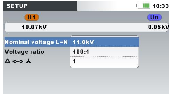
Abbildung 4.13: Beispiel für das Spannungsverhältnis eines 11 kV / 110 V-Wandlers
