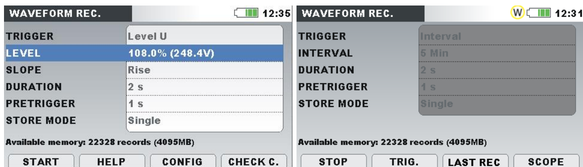
Abbildung 3.48: Bildschirm mit den Einstellungen des Wellenform-Rekorders
