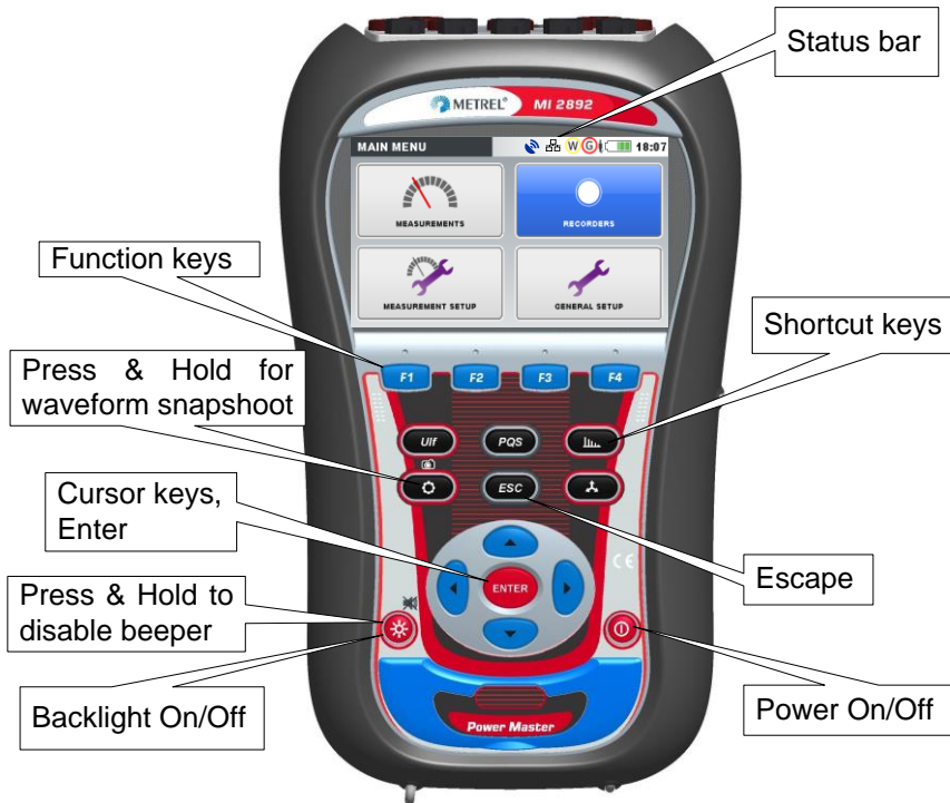
Abbildung 3.1: Beschreibung der Symbole auf dem Display und der Tasten
